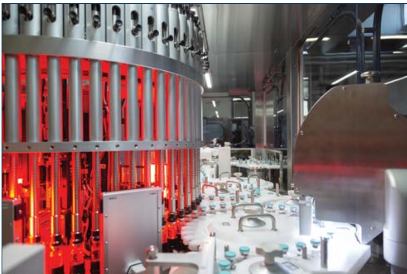
Plus 400 LKD: Лучшее решение среди систем подобного класса с высокими производительностью и уровнем гибкости. Данная машина имеет производительность до 400 ед/мин. и может работать с ампулами, флаконами и картриджами
