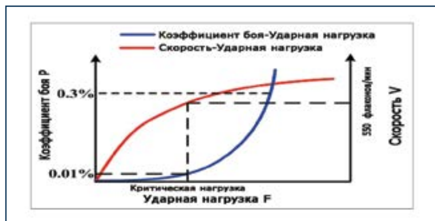
Рис. 1. График изменения ударной нагрузки на флаконы в процессе загрузки в машину
