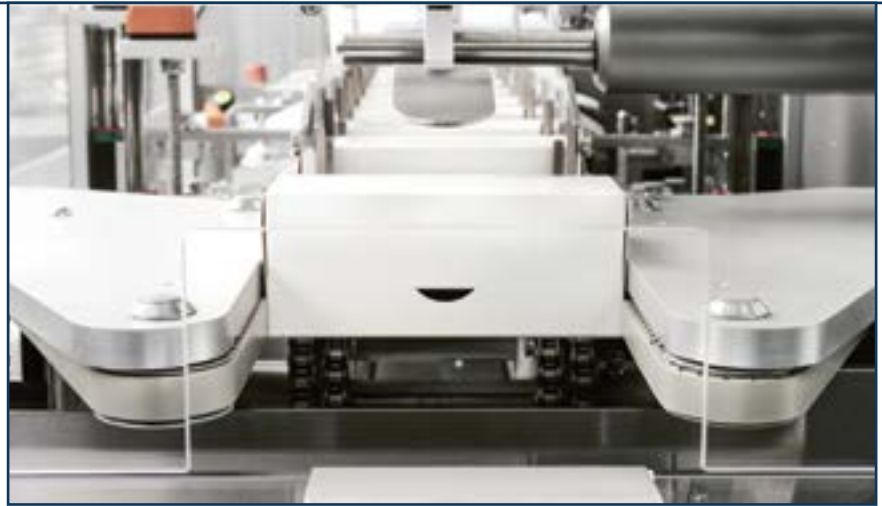
Упаковка саше в картонную пачку на картонажных машинах моделей X2 S / XLS 2
