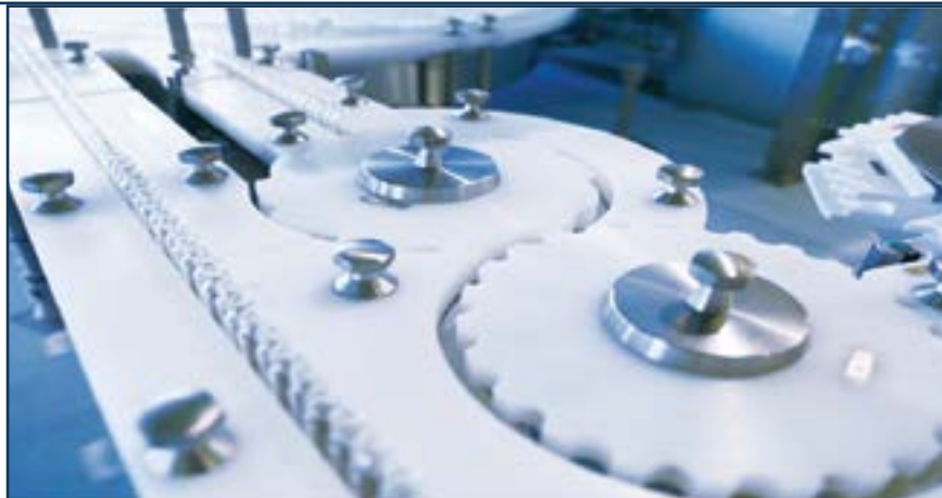
Рис. 2. Раздаточная звездочка и транспортировочная каретка
