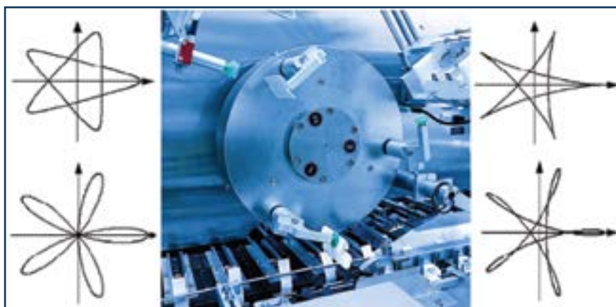
Рис. 8. Механизм захвата и раскрытия картонной пачки
