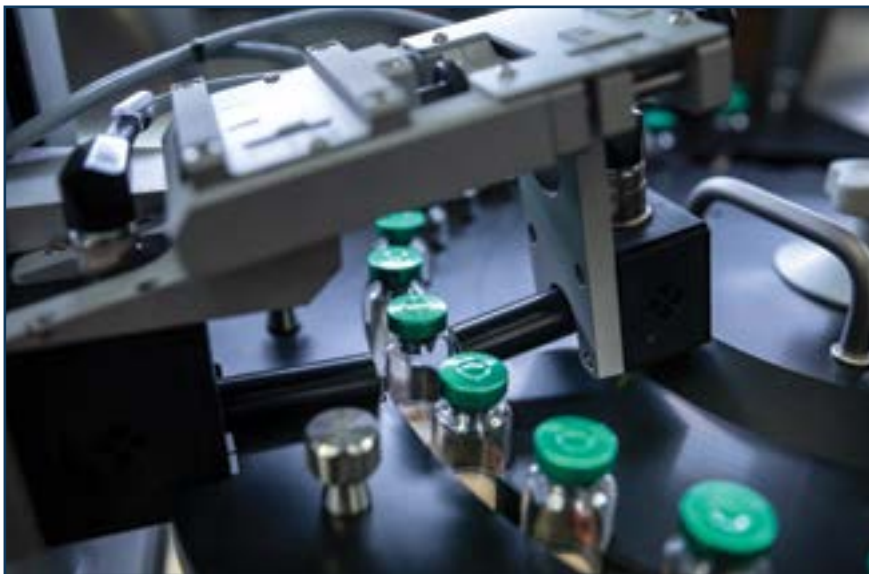
HVLD для определения целостности контейнеров с жидкими продуктами и HGA для инспектирования контейнеров с порошком и лиофилизированными продуктами
