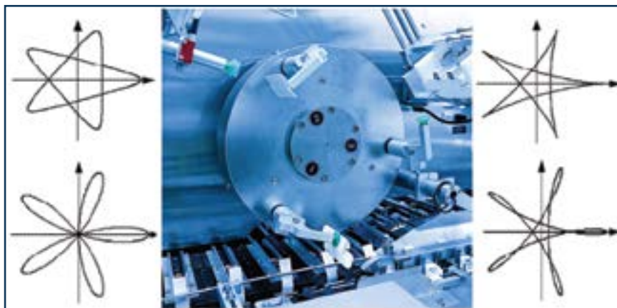
Рис. 8. Механизм захвата и раскрытия картонной пачки
