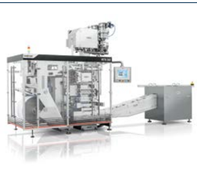
Машина модели BETA 360 для упаковки пакетов с 4 запайками
