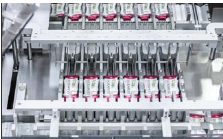
Упаковка саше в картонную пачку на картонажных машинах моделей X2 S / XLS 2
