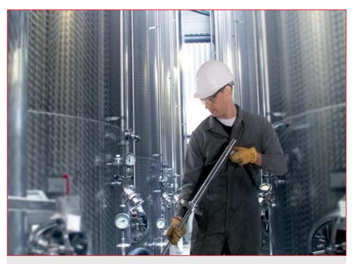
Мониторинг частиц и капель в режиме реального времени помогает обеспечить производство в соответствии с требованиями, предъявляемыми к технологическому процессу. Благодаря использованию in situ приборов для определения мутности, измерения коэффициента отражения сфокусированного пучка (FBRM®) и регистрации изображений (PVM®) количество отклонений можно уменьшить или даже
