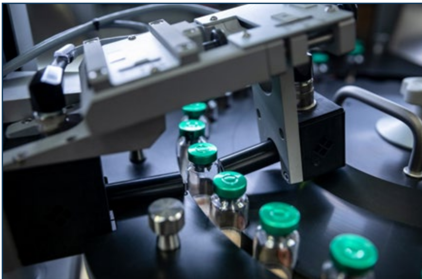
HVLD для определения целостности контейнеров с жидкими продуктами и HGA для инспектирования контейнеров с порошком и лиофилизованными продуктами
