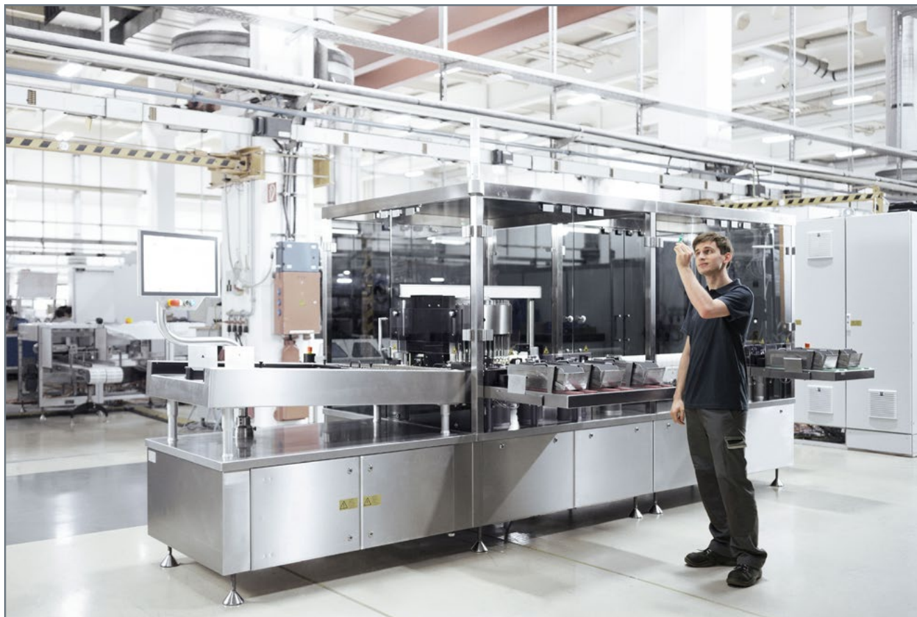
«Машина AIM 3000 является не только высокоскоростной, но и занимает меньшую площадь благодаря встроенному модулю HVLD»
