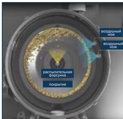
Рис. 1. Конструкция коутера ConsiGma®, используемого в данном исследовании
