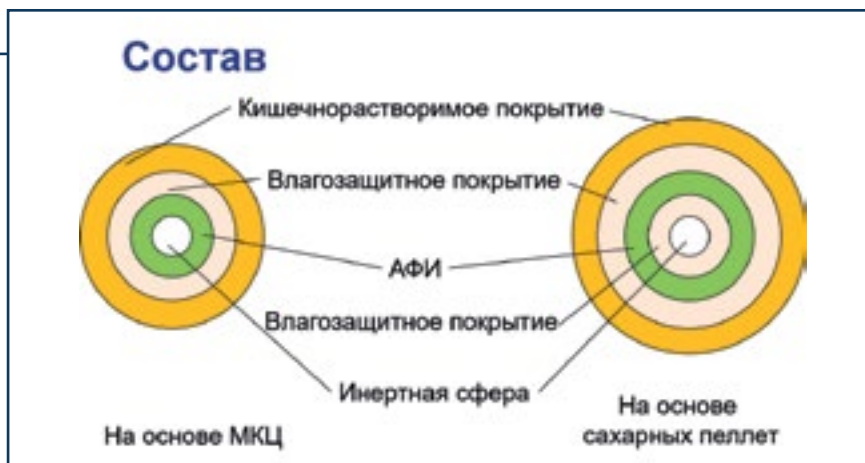
Рис. 6. Дополнительная стадия по нанесению специального влагозащитного барьера на поверхность сахарных сфер
