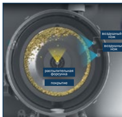
Рис. 2. Конструкция коутера ConsiGma®, использованного в данном исследовании
