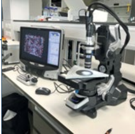
Рис. 5. Цифровой микроскоп Digital Microscope VHX-600 Series (Keyence Corp., Osaka, Japan) и визуализация определения дискретных частиц с его помощью (справа)
