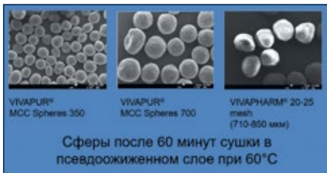
Рис. 5. Сферы были помещены на 60 мин в сушику в псевдооживленном слое при 60° C
