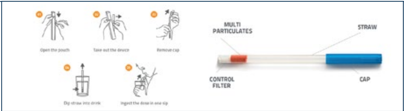
Рис. 1. XStraw® – новый подход, позволяющий дозировать в трубочку твердые частицы (MUPS), которые растворяются при употреблении жидкости через трубочку, тем самым нивелируя трудности и риски, связанные с проглатыванием. Источник https://d-s.technology/xstraw/
