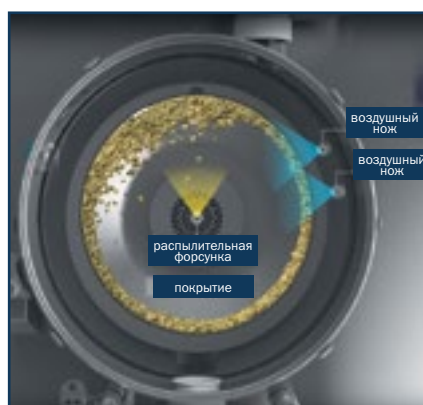
Рис. 2. Конструкция коутера ConsiGma®, использованного в данном исследовании
