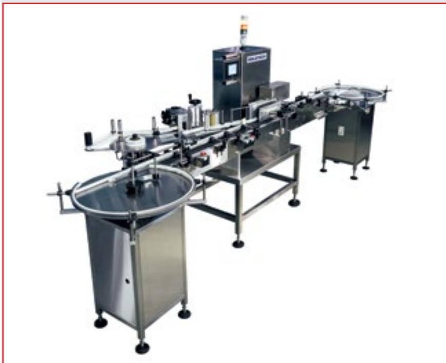
Рис. 1. Автомат нанесения этикеток ROLS-300 для флаконов
