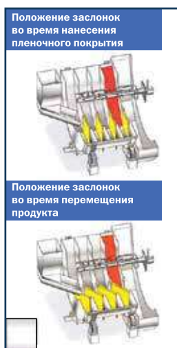
Рис. 3. Схема коатера Driacanti-T для полунепрерывного производства
