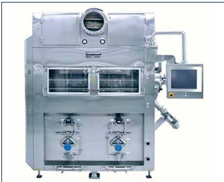
Фото. Недавно внедренные в производство коатеры малой производительности для полностью непрерывного производства, такие как коатер FCC 75 компании O'Hara , достаточно производительны, чтобы применять их для нанесения покрытий на продукты классического процесса скоростного таблетирования
