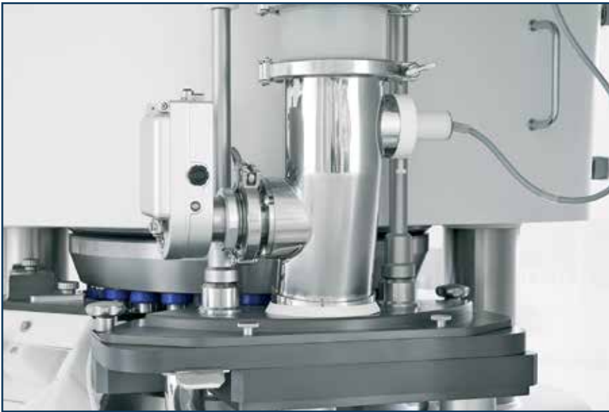
Рис. 1. MicroNIR на системе подачи Prexima 300 (IMA, Италия)
