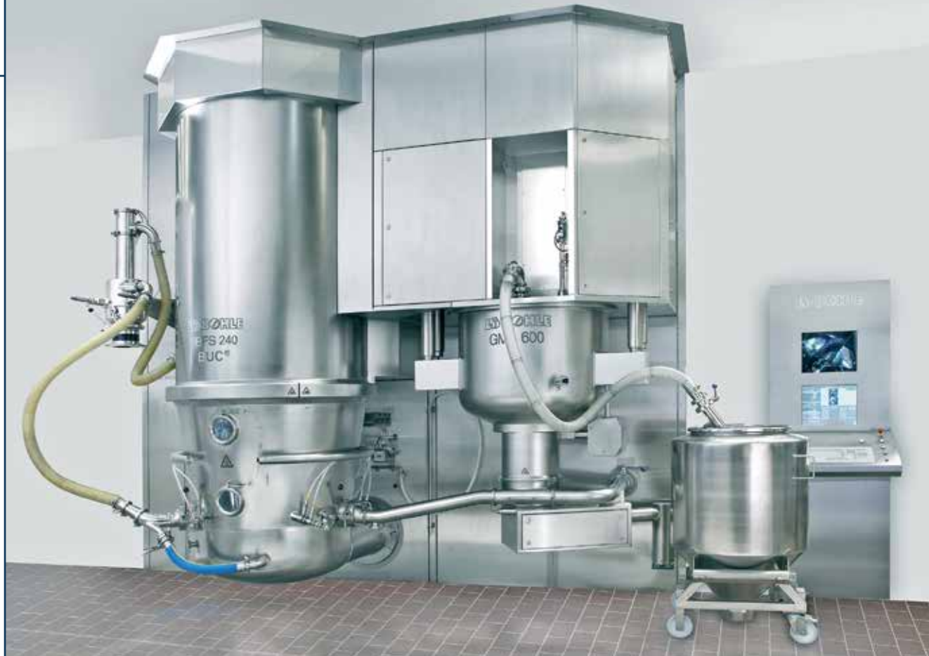
Рис. 2. Объединив многочисленные технологические преимущества и последовательную концепцию безопасности, компактная система грануляции устанавливает новые промышленные стандарты. Это делает данную компактную установку эффективным решением, особенно, когда речь идет об экономической и эргономической оптимизации классической влажной грануляции
