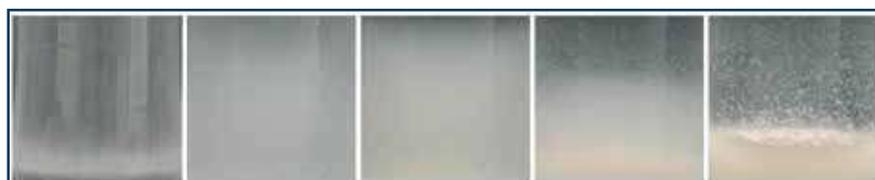
Рис. 3. Затвердевание полиоксил касторового масла при охлаждении от +40 °С до комнатной температуры (снижение температуры слева направо)
