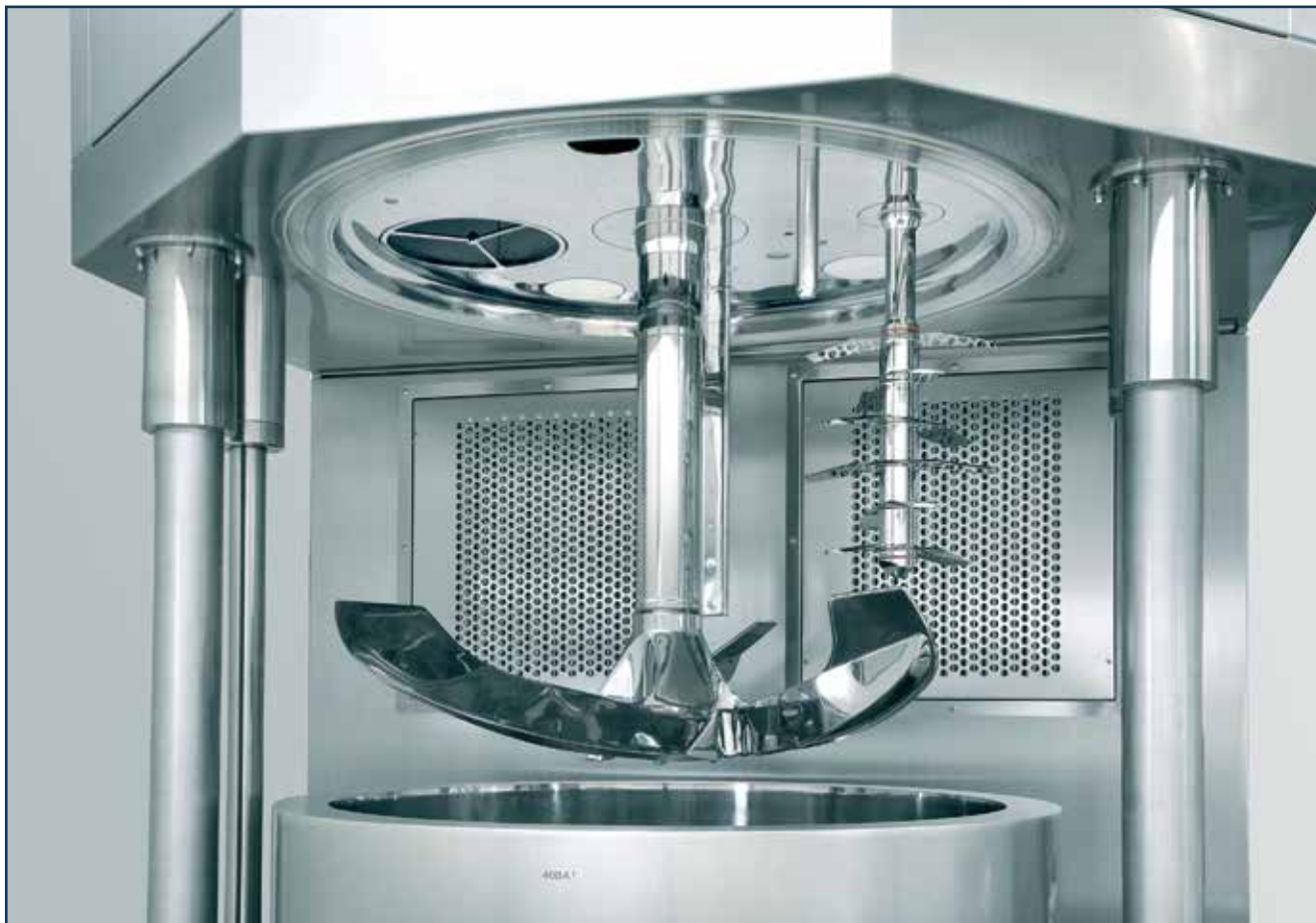
Рис. 1. Грануляция с высоким усилием сдвига является распространенным способом производства твердых лекарственных форм для перорального применения. Компания L.B. Vohle предлагает широкое портфолио решений для грануляции с высоким усилием сдвига, включая системы R&D для небольших и промышленных масштабов
