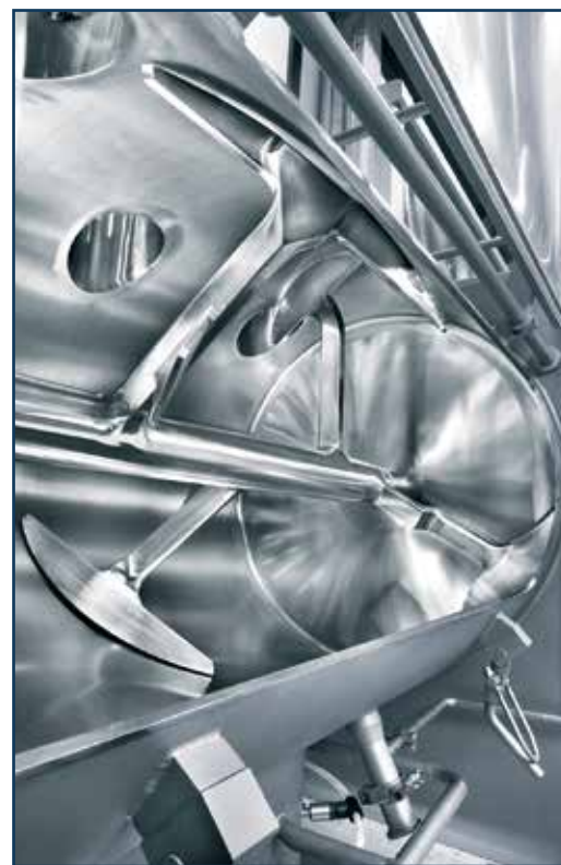
Решающее влияние на пригодность для производственных процессов с высокими гигиеническими требованиями оказывают выбор подходящих материалов и геометрическая конструкция рабочего оборудования (источник: Lödige)
