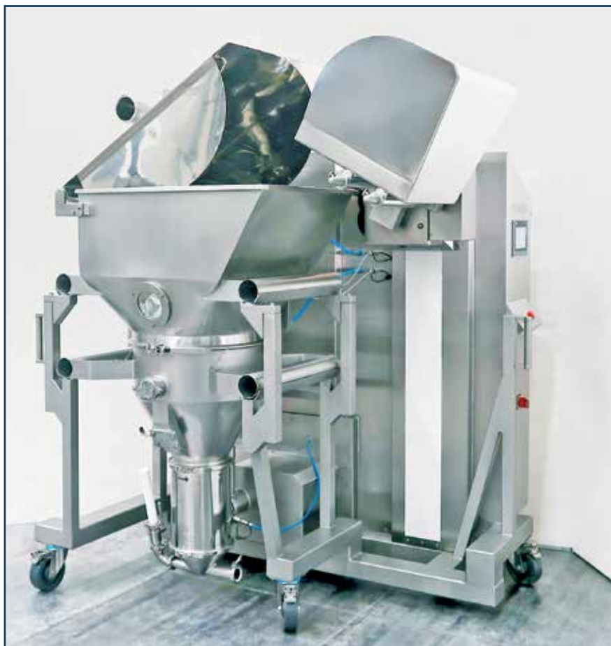
Рис. 1. Новая разработка компании L.B. Bohle позволяет производить метформин эффективно и в больших объемах. На мобильной станции осуществляются измельчение, дробление комков и просеивание метформина
