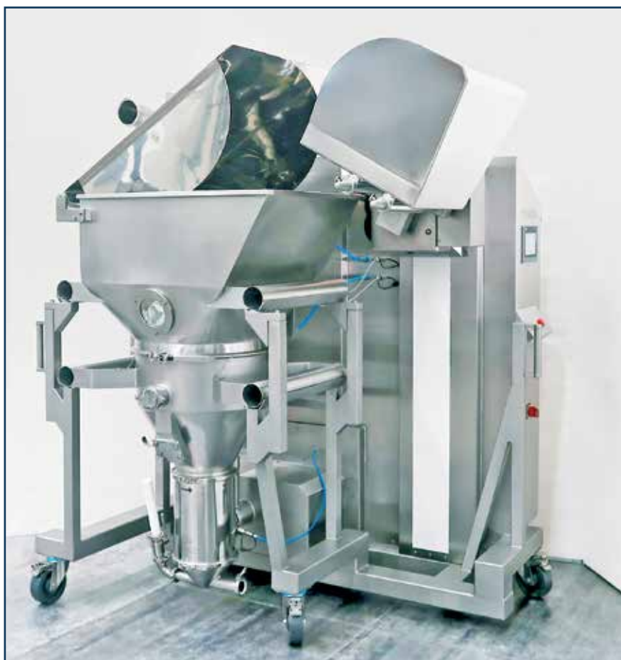
Рис. 1. Новая разработка компании L.V. Bohle позволяет производить метформин эффективно и в больших объемах. На мобильной станции осуществляются измельчение, дробление комков и просеивание метформина
