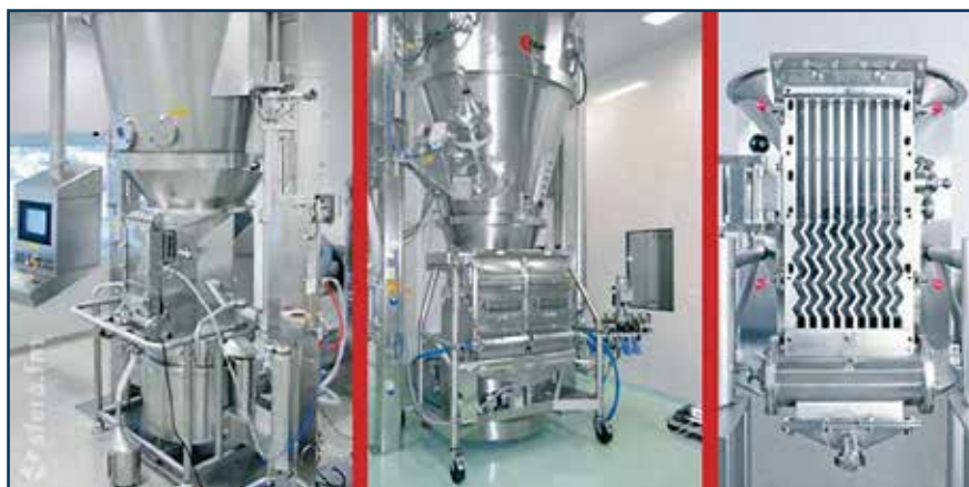
Слева направо: пилотная установка GPCG 30/60 с псевдооживленным слоем Glatt с модулем MicroPx, производственная установка GPCG-120/200 с модулем MicroPx, зигзагообразный классификатор модуля MicroPx для GPCG 30/60
