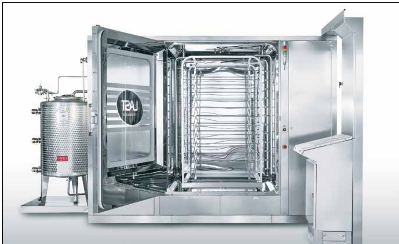
Моечная машина UCW для работы с ацетоном
