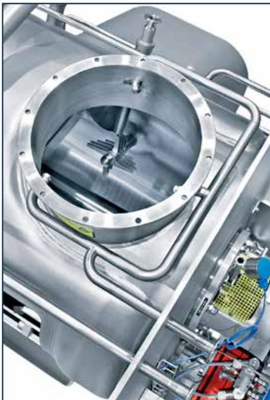
Разделение черного и белого способствует предотвращению распространения загрязнения. С технической точки зрения это означает, например, пространственное разделение двигателя для привода смесителя или другой технологической машины от самой машины (источник: Lödige)
