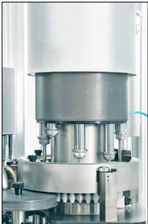
Капсулонаполнительная машина модели MG Compact: узел дозирования порошкообразных препаратов
