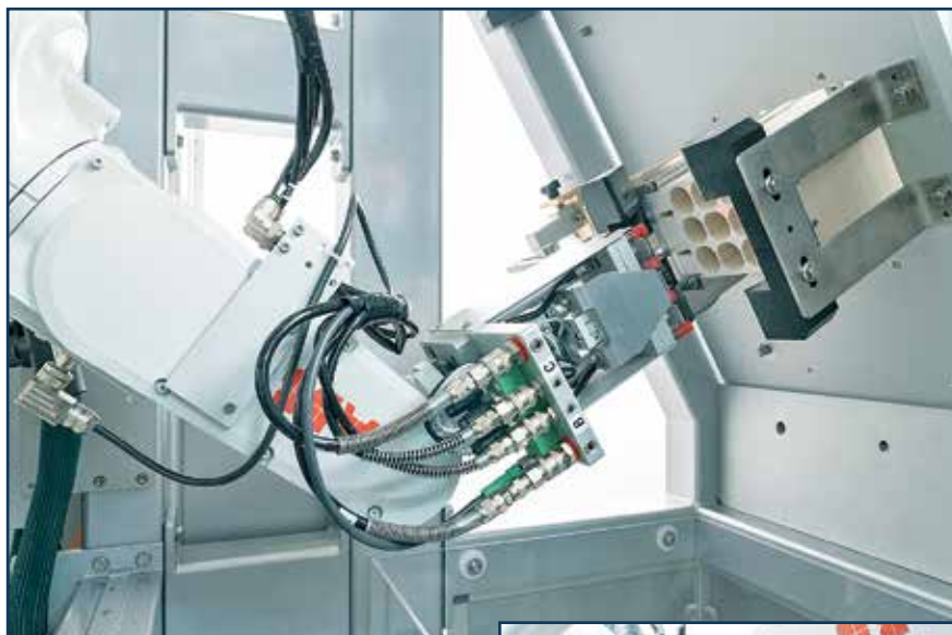
Машина GTF60 обрабатывает коробочки и флаконы с помощью шестиосевого робота
