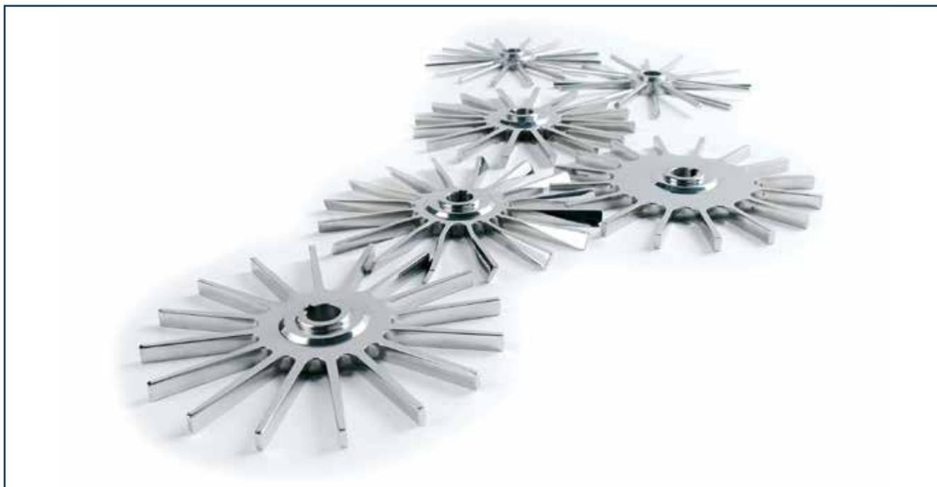
Рис. 2. Возможные формы профиля лопатки
