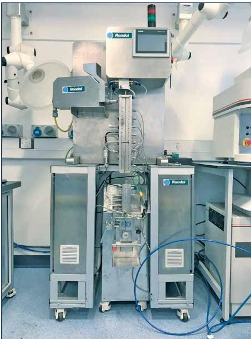
Рис. 10. Вертикальный двухшнековый экструдер (Rondol Industrie, Франция). Снимок сделан автором в лаборатории группы фармацевтического инжиниринга в Queen's University Belfast (Северная Ирландия, Великобритания)
