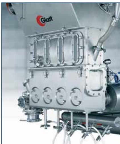
Рис. 5. Непрерывные гранулятор/коатер псевдооживленного слоя (Glatt GmbH, Германия)
