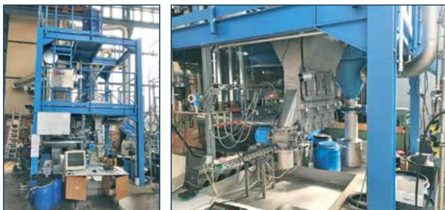
Рис. 6. Непрерывные гранулятор/коатер псевдооживленного слоя (Glatt GmbH, Германия): слева – общий вид установки; справа – вид рабочей камеры сбоку. Фотоснимки были сделаны автором во время рабочего визита в группу инжиниринга процессов и систем в Otto-von-Guricke Universität в Магдебурге в апреле 2019 г.
