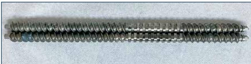
Рис. 9. Пример шнеков с наборными подающими-перемешивающими-подающими элементами для лабораторного экструдера
