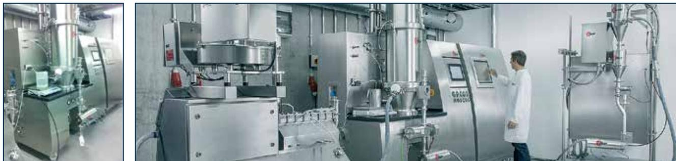
Рис. 7. Слева – псевдооживленная сушка квазинепрерывного действия GPCG2 MODCOS (Glatt, Германия). Снимок сделан автором во время технологических испытаний в лаборатории Glatt в Бинзене в феврале 2017 г. Справа – эта же сушка (по центру), вписанная в непрерывный технологический процесс влажной грануляции и сушки (слева на фотографии изображен двухшнековый экструдер)
