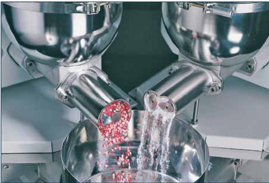
Рис. 2. Справа – двухшнековый питатель непрерывного действия, слева – одношнековый смеситель непрерывного действия (рисунок с сайта *Coperion K-Tron America*, США)
