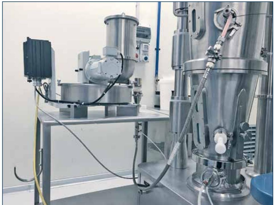
Рис. 3. Двухшнековый вибрационный питатель (*Coperion K-Tron America*, США; слева), который подает порошковый глидант на трехпозиционную форсунку (порошок, жидкость и газ) установки для нанесения оболочек VFC-LAB-3 в псевдооживленном слое (*Freund-Vector Corp.*, США; справа). Снимок сделан автором во время технологических испытаний в лаборатории *Freund-Vector* близ Милана в марте 2018 г.
