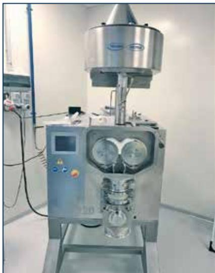
Рис. 4. Роликовый компактер TFC-220 (Freund Vector, США). Снимок сделан автором во время технологических испытаний в лаборатории Freund-Vector близ Милана в марте 2018 г.
