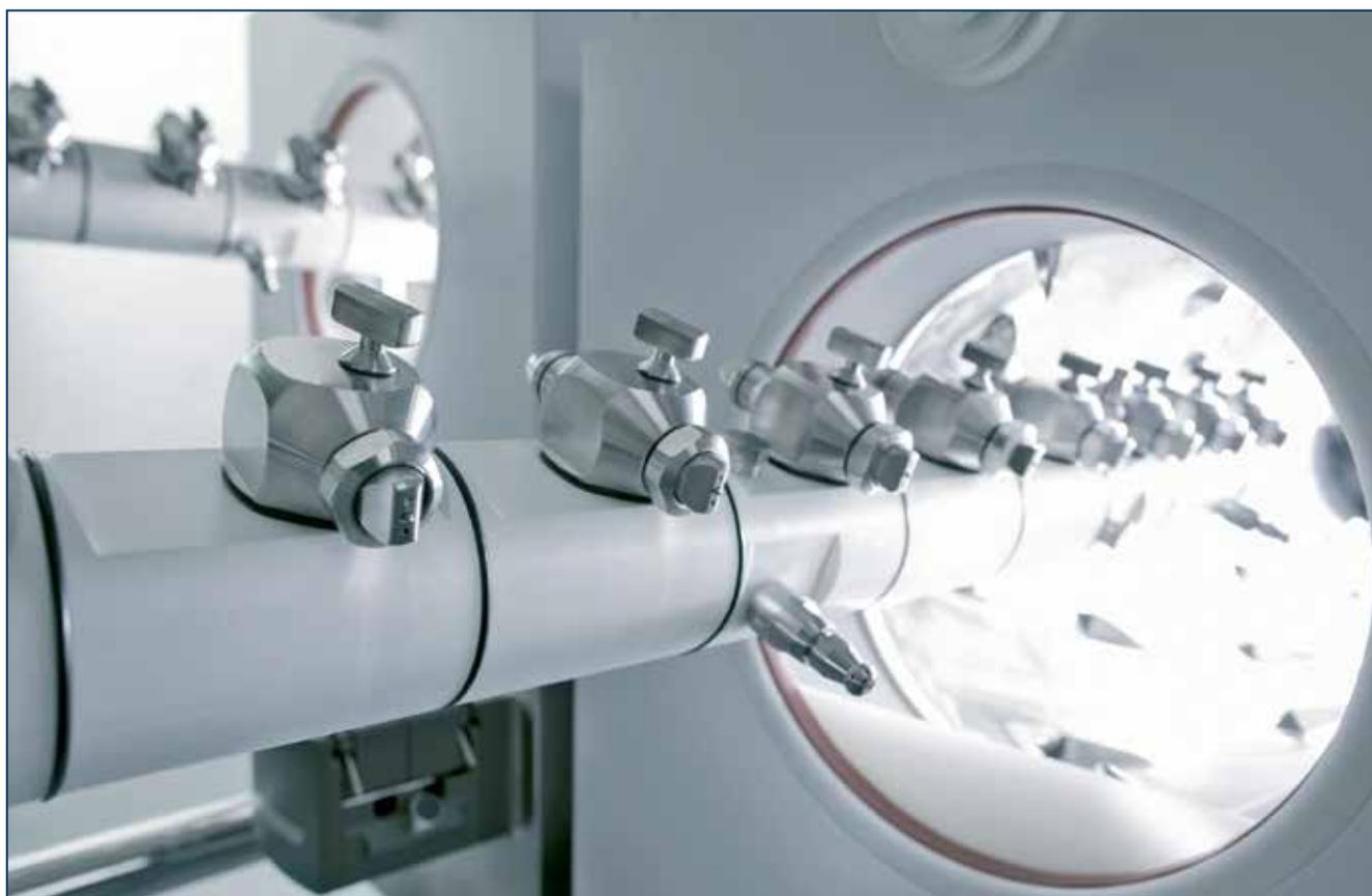
Рис. 11. Барабанный коатер непрерывного действия
