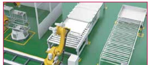
Станция промывки и просушки полок после сварки
