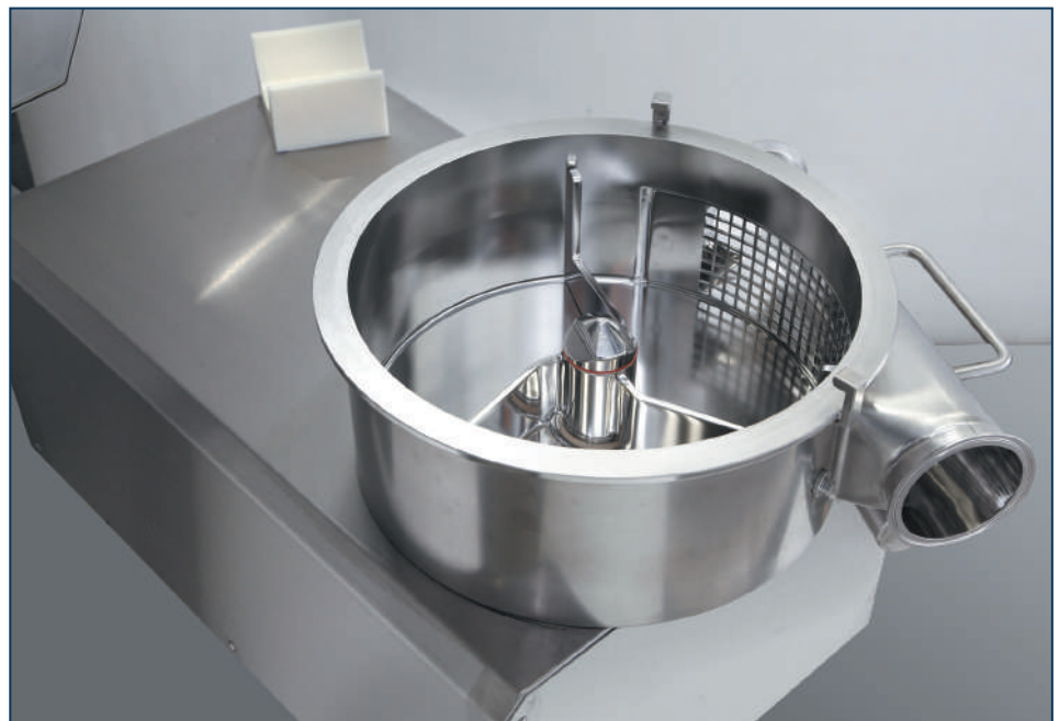
Тангенціальний млин для вологого помолу гарантовано запобігає блокуванню продукту в процесі передачі на сушку BFS
