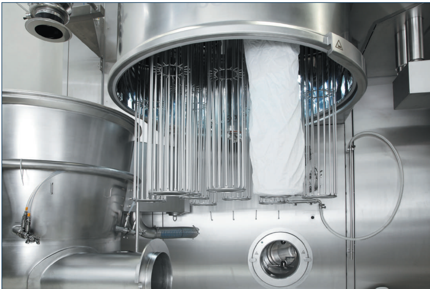
Переваги інспектування: легке опускання фільтрів до ергономічної робочої висоти
