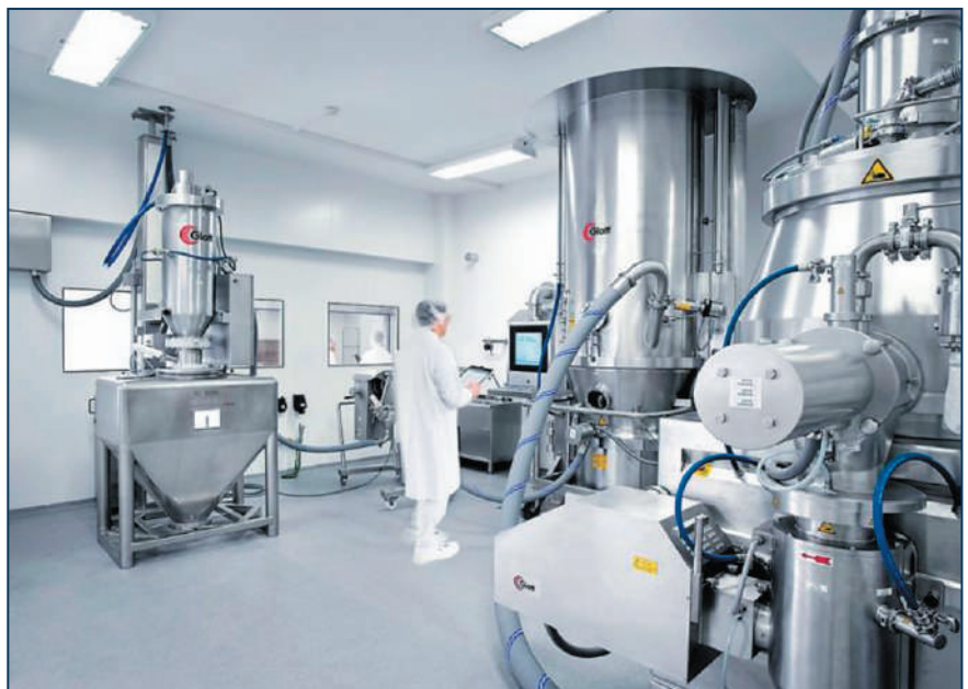
Герметичне виробництво дозволяє операторам працювати без захисних костюмів. Фото: Glatt
