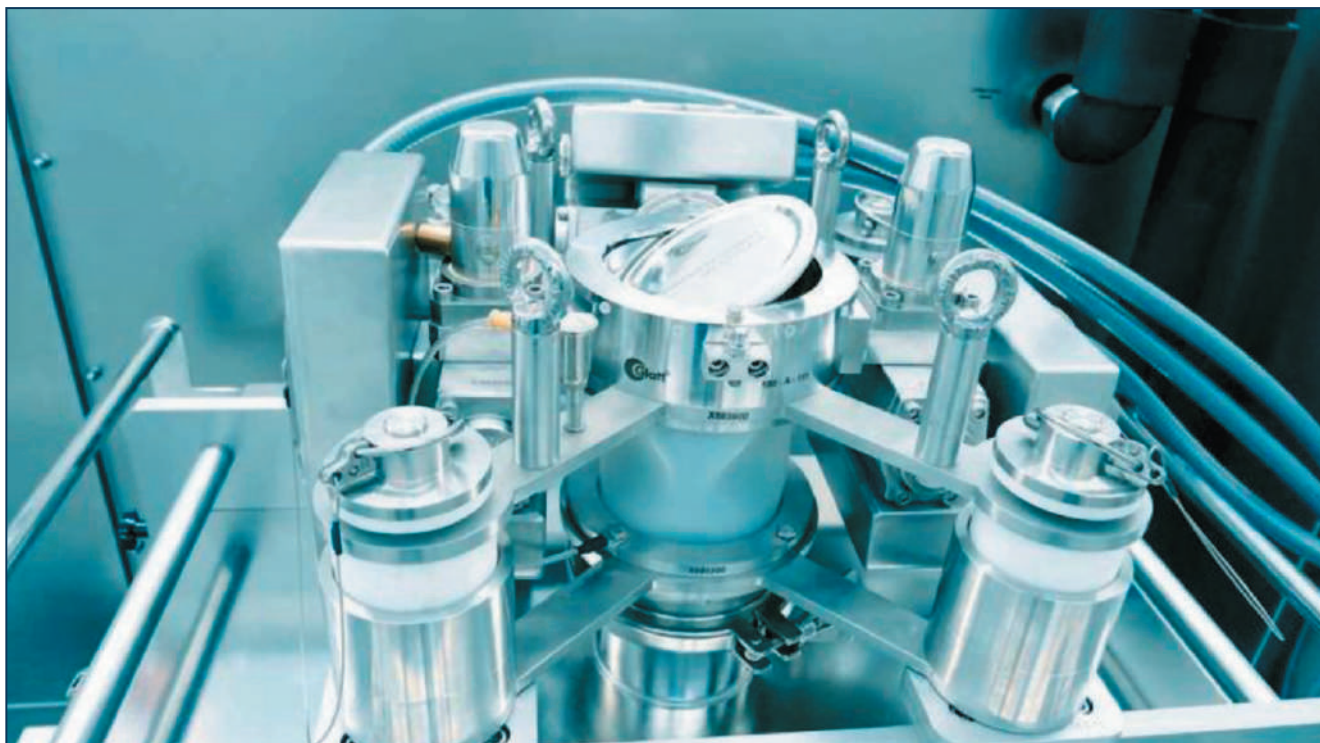
Використання клапана виробництва Glatt у блістерній машині компанії Uhlmann: коли йдеться про рішення для герметизації, сьогодні це звучить так: «мінімальний наскільки можливо, великий наскільки потрібно». Фото: Uhlmann
