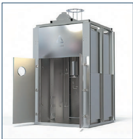
Мийка для бінів від виробника PAT Group. Ополіскування та мийка відбувається одразу зсередини і зовні контейнера. Має дві двері із системою блокування для розділення «брудної» і «чистої» зони
