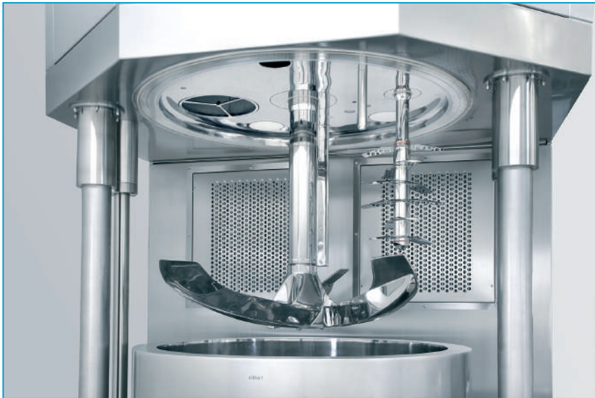
Лезо мішалки з його здатністю високого зсуву та компактування гарантує ефективну грануляцію, завдяки чому формуються щільні гранули
