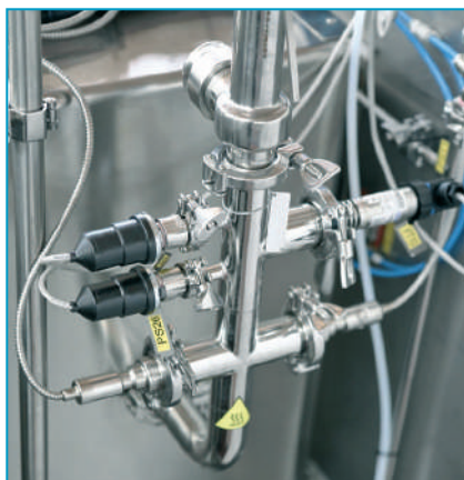
Трубопроводи для автоклава RSA виготовлені з нержавіючої сталі марки 316L із внутрішньою поліровкою до досягнення шорсткості <0,35 мкм.
