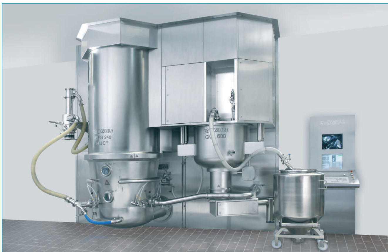
Компактний модуль дозволяє значно заощадити площу для установки обладнання завдяки тому, що гранулятор з високим зусиллям зсуву та сушка в псевдозрідженому шарі розташовані поруч
