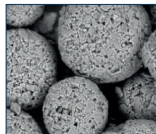
Рис. 3. Скануюча електронна мікроскопія (SEM) Kollitab™ DC 87 L
