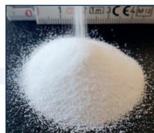
Рис. 1. Вільносипкий порошок Kollitab™ DC 87 L
