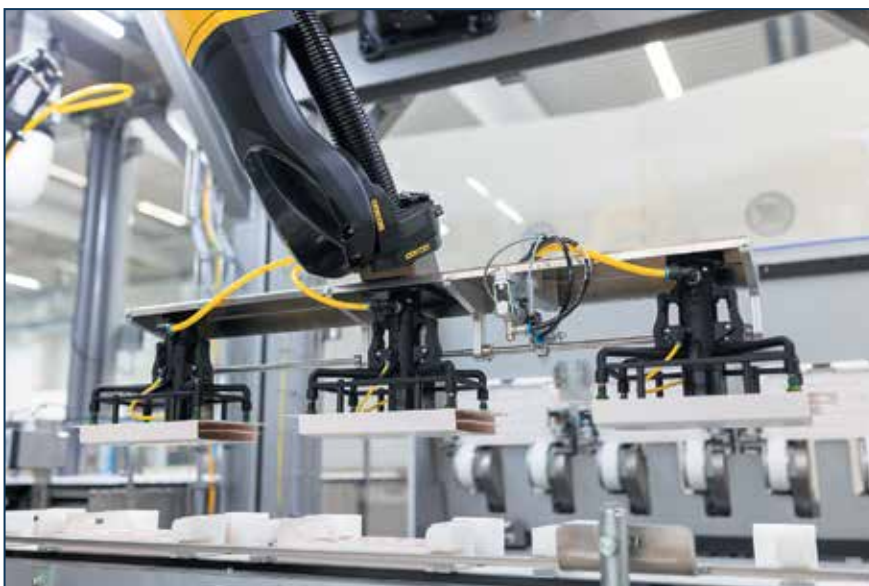
Фото 4. Шестиосьовий робот встановлює картонні вставки
