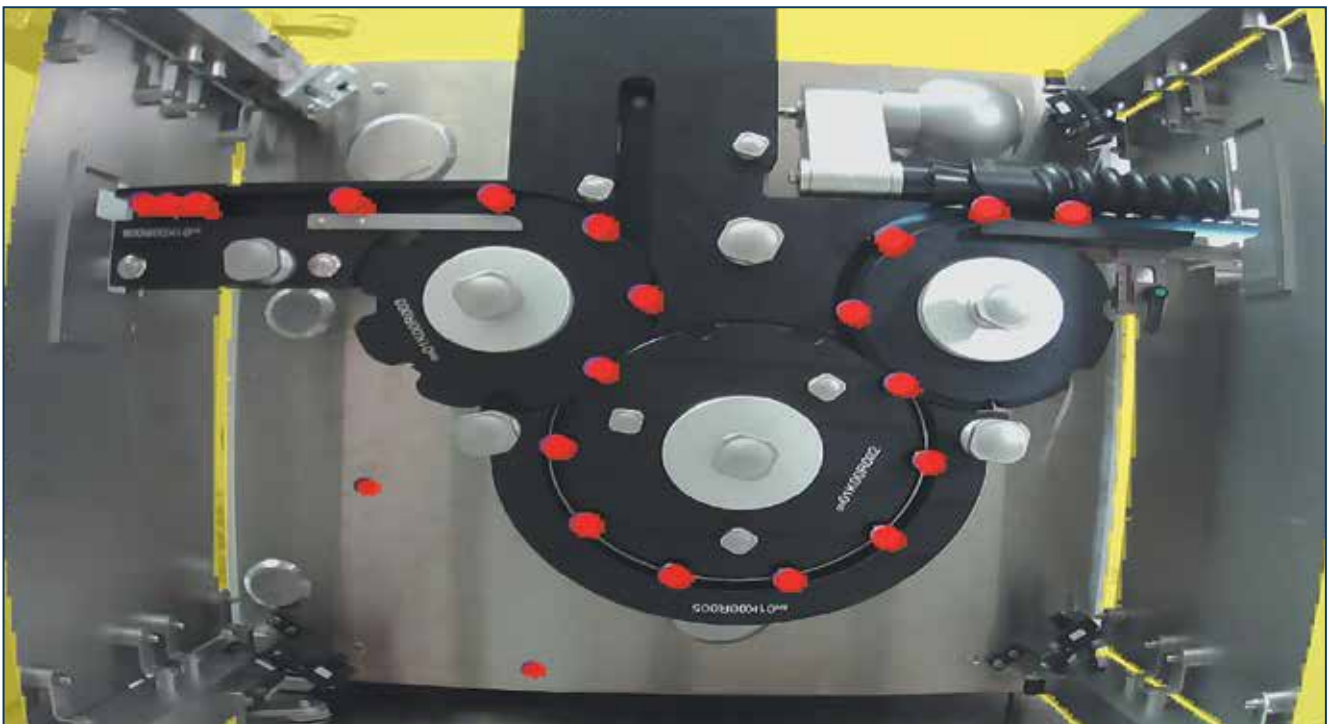
Автоматизований контроль очищення ліній на основі ШІ
