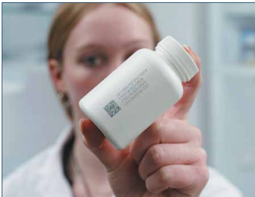
Фото 5. Лазер для УФ-маркування Domino U510 не використовує пігменти/добавки для самоактивації або спеціально підготовлені поля для маркування за рахунок фотохімічної реакції
