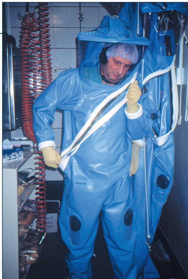
Рис. 4. Приклад сучасного костюма із повною маскою та подачею повітря для дихання (засоби індивідуального захисту)
