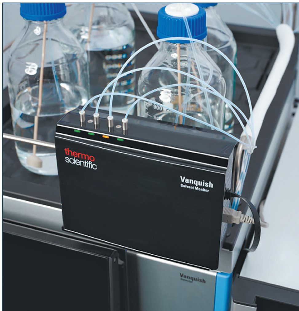
Моніторинг розчинників Vanquish розширює можливості системи ВЕРХ та УВЕРХ Vanquish для точного та автоматичного вимірювання рівня рідини у кожному окремому каналі розчинника та контейнері для відходів
