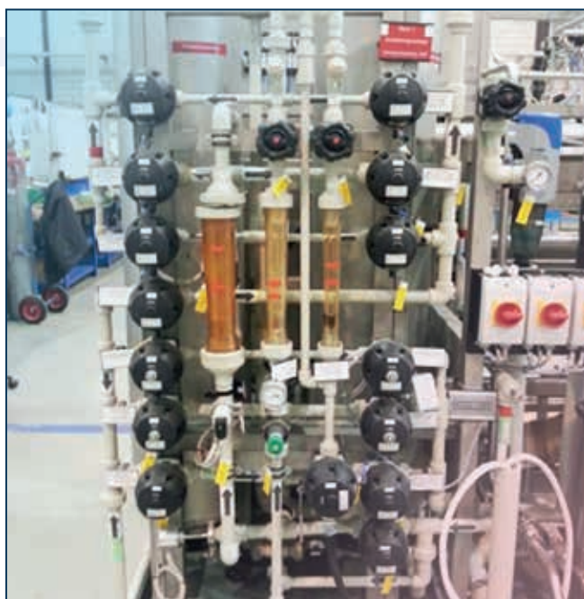
Компонування із застосуванням одинарних клапанів
