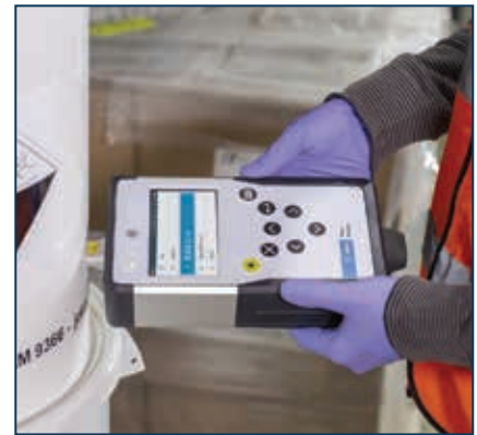
Рис. 3. Ідентифікація на складі крізь непрозору упаковку за допомогою спектрометра Agilent Vaya
