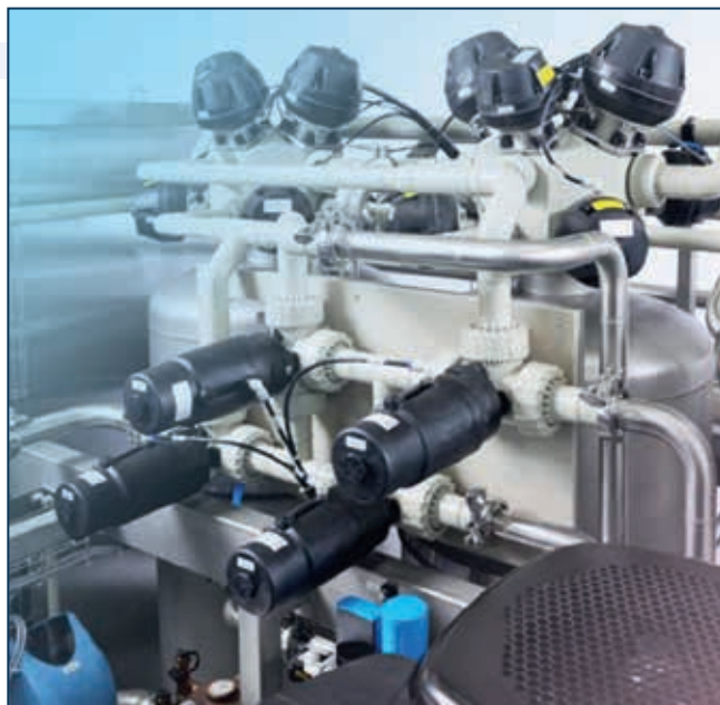
Вдосконалене компонування вузла керування пом'якшувачем завдяки багатопортовим запірним клапанам
