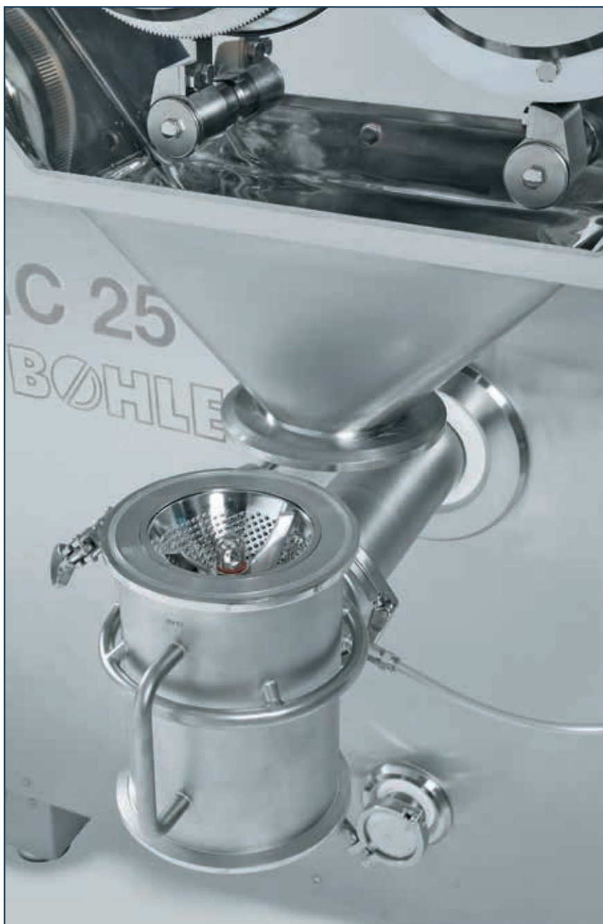
Установка сита на грануляторі моделі BRC 25
