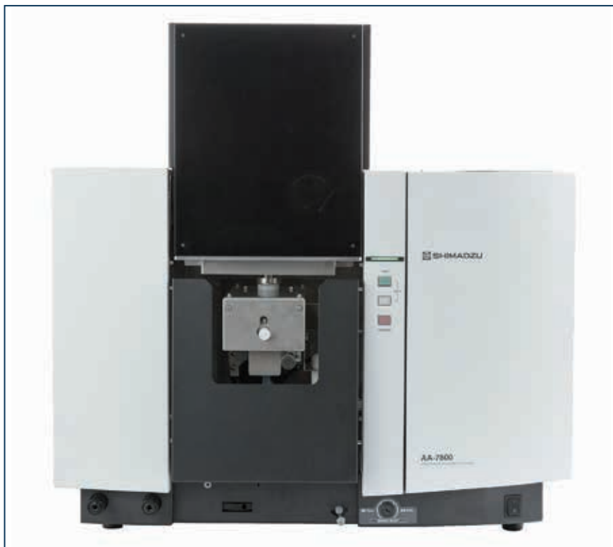
Фото № 2. Атомно-абсорбційний спектрометр моделі AA-7800F
