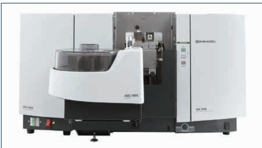
Фото № 3. Атомно-абсорбційний спектрометр моделі AA-7800G
