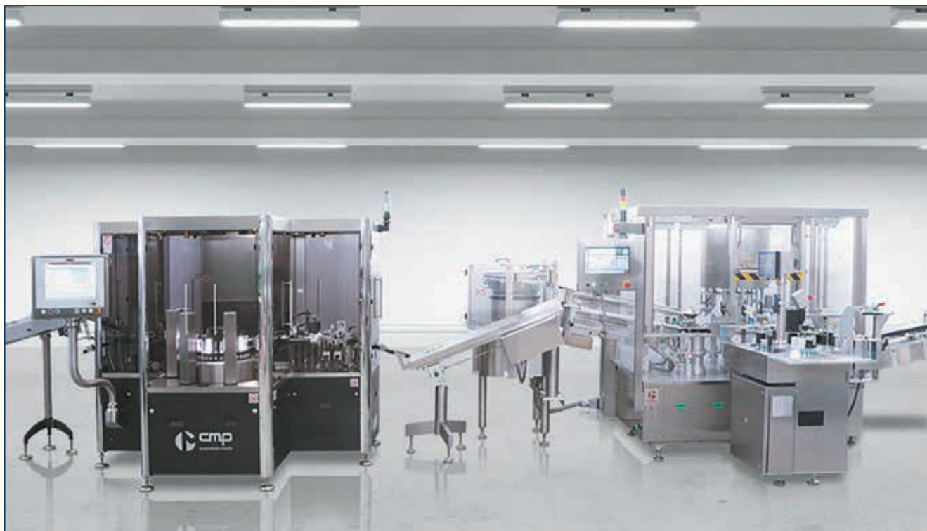
Лінія Marchesini Group для перевірки та збору попередньо наповнених шприців складається з інспекційної машини моделі SA12J від CMP Phar.ma та машини Corima Combi 1/2 PL, що призначена для збору одноразових шприців (вставки поршня) і маркування їх самоклеючими етикетками
