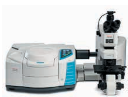
Рис. 11. ІЧ-Фур'є спектрометр Nicolet iS20 з мікроскопом Nicolet iN5
