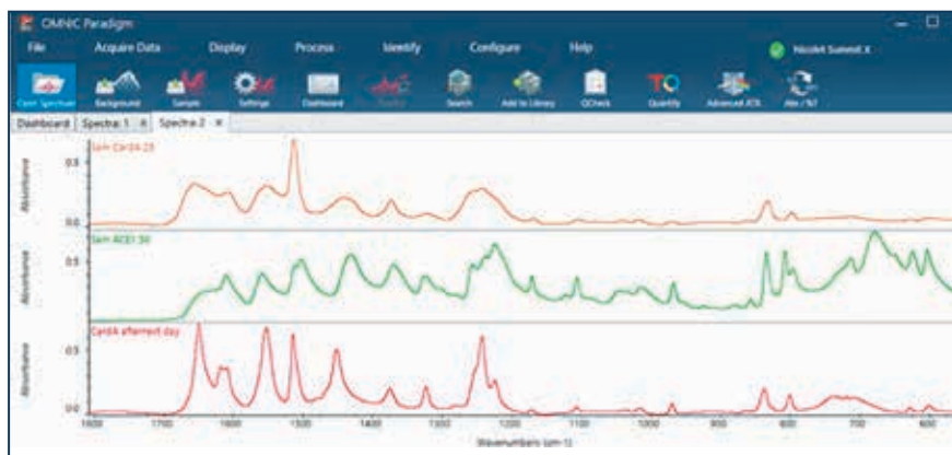
Рис. 3. Спектри трьох «кінцевих» поліморфів ацетамідофенолу, отриманих за різних умов. Спектр А відповідає аморфній формі ацетамідофенолу, спектр В — моноклінному поліморфу, спектр С — орторомбічному поліморфу
