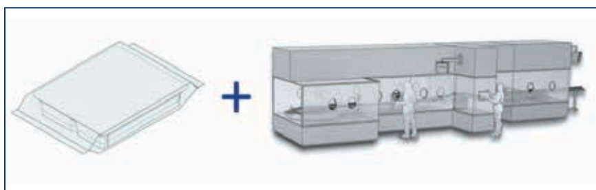
Рис. 6. Оптимізована лінія для асептичного наповнення у флакони (машина для наповнення, блок укупорювання пробками та блок закатки ковпачками)
