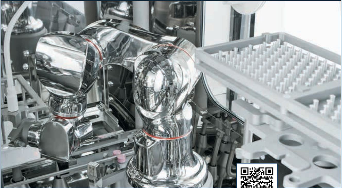
Лінія INJECTA для наповнення високоактивних препаратів. Переміщення контейнера із гнізда і його повторна установка у гніздо на піддоні
