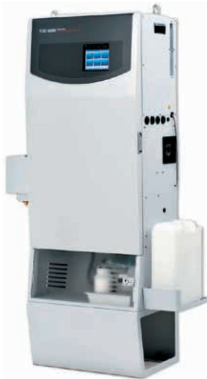
Фото № 4. Автоматичний 6-канальний ТОС-аналізатор моделі ТОС-4200
