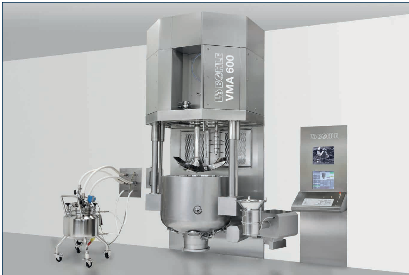
Гранулятор VMA: лінійка грануляторів VMA включає класичні одномодульні гранулятори з агітатором та чопером і верхнім приводом. Можливе виробництво партій обсягом від 20 до 960 л
