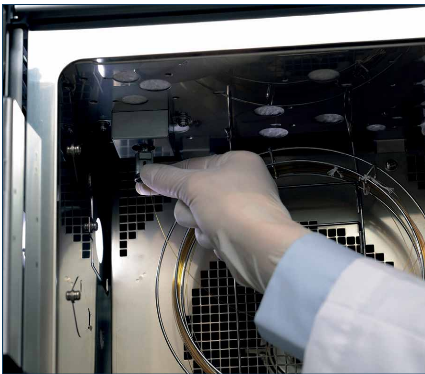
Фото № 3. Заміна колонки
