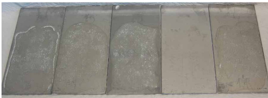
Рис. 5. Залишки стеаратів у вигляді білого порошку на поверхнях обладнання та утворення крапель води як індикатор стійкої гідрофобності
