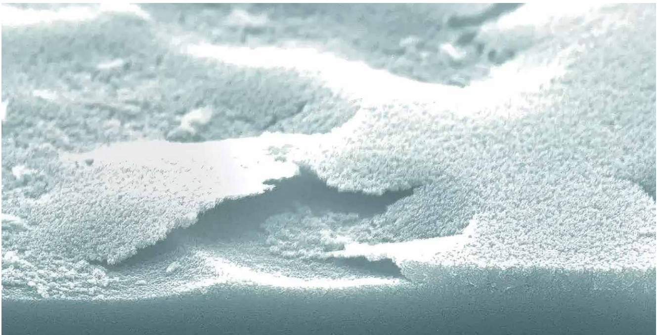
Рис. 1. Внутрішня поверхня сильно кородованого контейнера з боросилікатного скла (SEM-зображення, \times 100\,000 )
