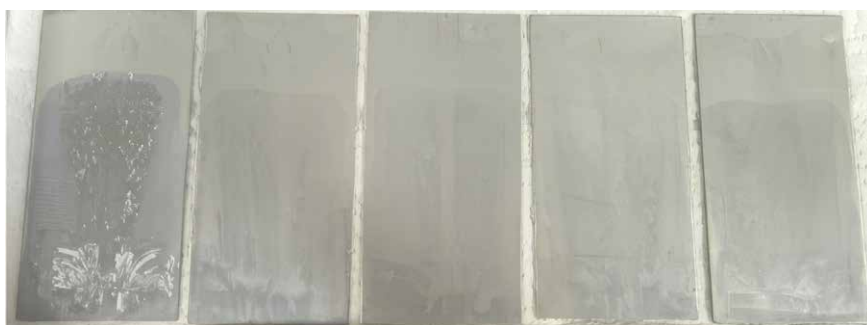
Рис. 4. Утворення білих плям і плівок у разі надмірно інтенсивних або тривалих циклів очищення від титану діоксиду
