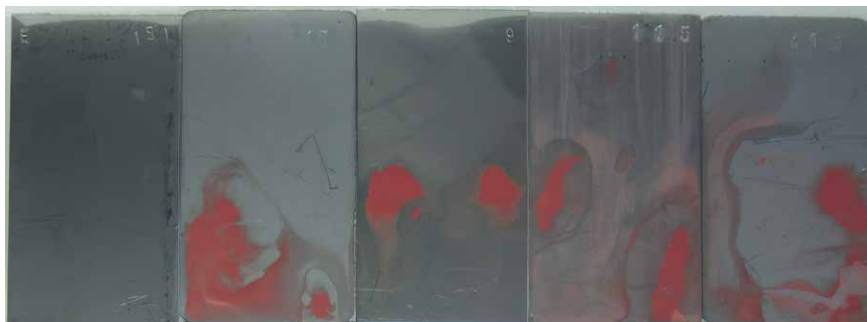
Рис. 3. Повторне осадження пігменту на поверхнях обладнання за неефективного очищення від оксидів заліза
